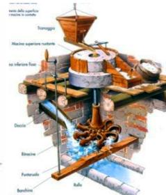
Fig. 26 – Maggiori dettagli dello schema tipologico del mulino di Cartiera.
