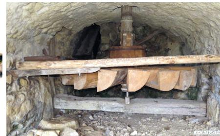
Fig. 27 – Schema costruttivo della ruota orizzontale sotto l'impalcato delle macine.
